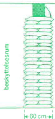
Fig. 22c (set fra siden) Lukning af døråbning.
