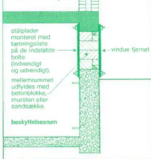
Fig. 10 (set fra siden) Eksempel på vinduesåbning efter lukning med 2 stk. 10 mm stålplader
