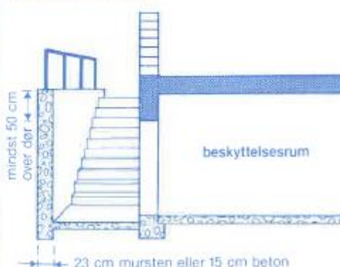
Fig 66 a (set fra siden) Udvendig adgangsdør afskærmet af kældertrappens væg.
