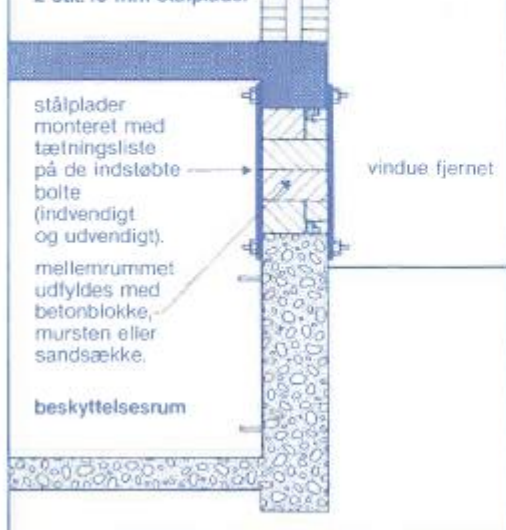
Fig. 51 (set fra siden) Eksempel på vinduesåbning efter lukning med 2 stk. 10 mm stålplader
