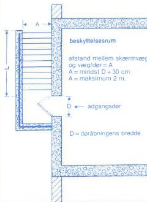
Fig. 66 b (set ovenfra) Udvendig adgangsdør afskærmet af kældertrappens væg.
